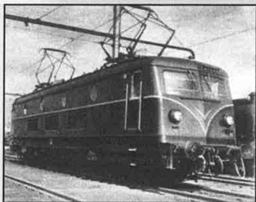
BB 123 de la SNCB (93 tonnes, 125km/h).
